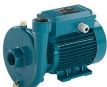
**Bomba Centrifuga Horizontal de Impulsor abierto** en hierro fundido y bronce para paso de sólidos de 4 mm conexión roscada para aplicaciones con líquidos abrasivos, emulsiones, agricultura, agua de mar y agua limpia con presencia de arena.
