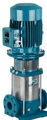
**Bomba Centrifuga Vertical Multi-Etapa** para alta presión con motores a 1750 rpm y 3500 rpm en construcción de acero inoxidable 304 y 316, con conexiones en rosca o brida.
