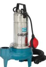
**Bomba Centrifuga Sumergible** en acero inoxidable 3013 y succión en hierro fundido con impulsor tipo vortex conexión roscada y brida con paso de sólidos de 50 mm para agua pluviales, aguas residuales, lodos y líquidos compatibles con los materiales de construcción.
