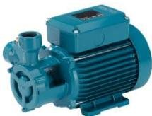
**Bomba Periférica Horizontal** en hierro fundido y bronce para aplicaciones donde se requiere poco flujo y alta presión en líquidos sin presencia de sólidos, equipos de maquinado, recirculación de líquidos y aceites de alta temperatura y equipos OEM.
