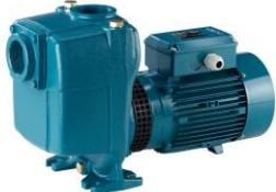
**Bomba Centrifuga Autocebante** en hierro fundido y bronce con impulsor semi abierto con paso de sólidos de 10mm a 15mm conexiones roscadas y con opción a cambiar el impulsor a cerrado con filtro integrado para sólidos para aplicaciones industriales con diferentes líquidos.
